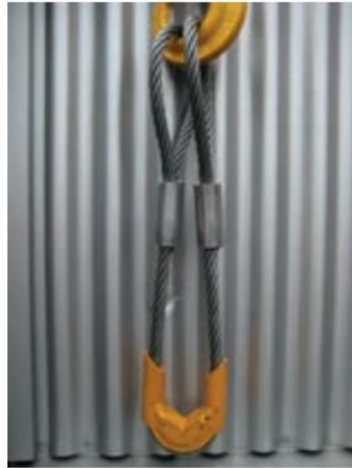
Damwandstrop met stalen beschermingskous
